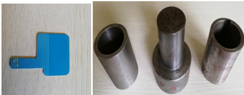
图2 设计加工的定位片和假轴轴套
